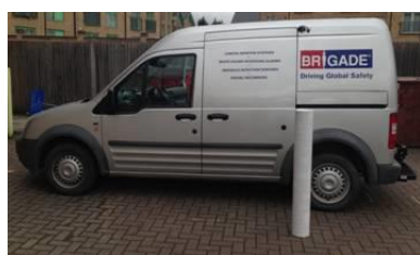
Poste de 1 m de alto bajo una cámara colocada a 1,8 m
