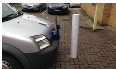
Poste de 1 m de alto frente a una cámara colocada a 0,6m
